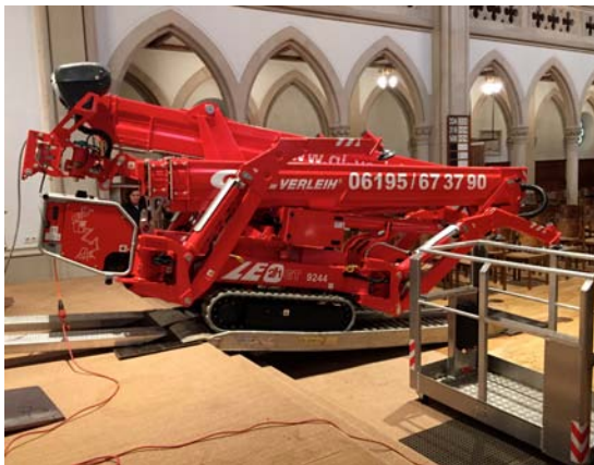
Abb. 03 Die Arbeitsbühne Teupen Leo21GT wird in den Chorraum verbracht (08.10.2014).
